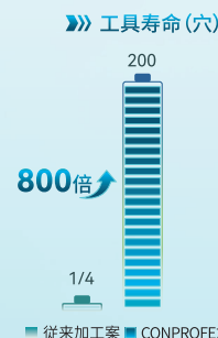
加工材料: アルミベース炭化ケイ素 (炭化ケイ素の含有量が60%)
