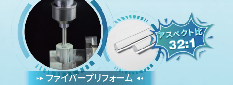
材料: 石英ガラス 寸法: D30x250mm 穴壁の粗さ: Sa<0.8μm 加工特徴: 二つのD7.8x250mmスルーホール
